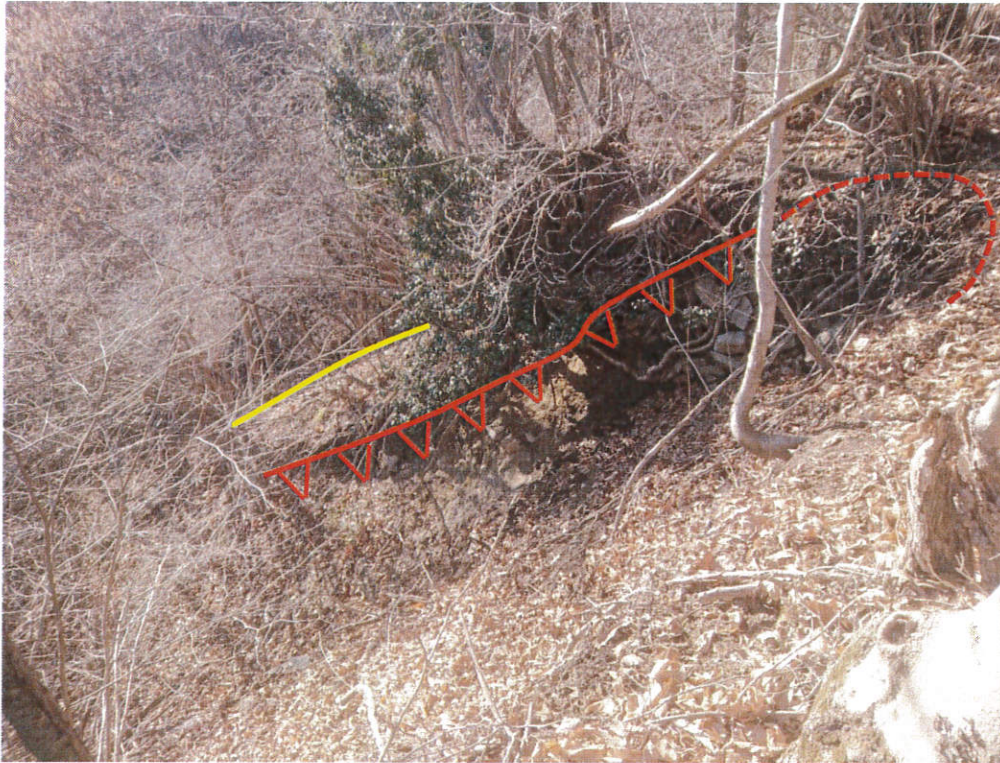
Foto 5 : Nicchia di stacco a fianco di un'altro orlo di erosione creando un dosso nella morfologia.
